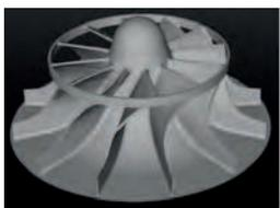
IMPELLER 3D LASER SCAN
